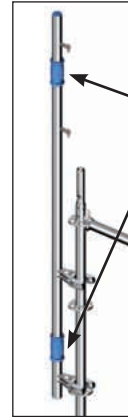
Bild 34: Anschluss Montagepfosten am Stiel
