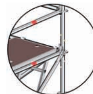
Bild 88: Verbindung der Stiele mit verschraubtem Rohrverbinder
