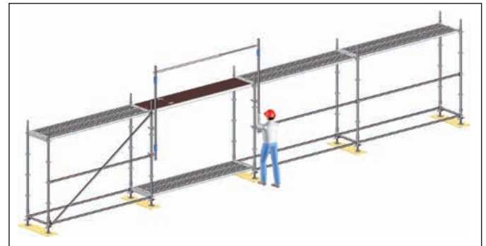
Bild 35: Anwendung des MSG im Aufstiegsfeld
