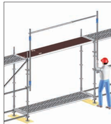
Bild 36: Detail der Montage des MSG im Aufstiegsfeld
