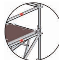
Bild 87: Verbindung der Stiele mit Fallstecker
