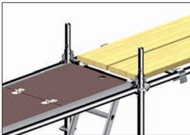
Bild 51: Montagedielen auf Auflagerriegel
