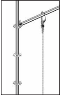
Bild 30: Anschlag an einem O-Riegel
